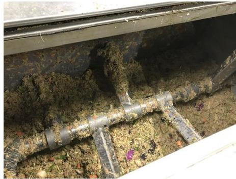
相模原第二工場では食品消滅機を導入しています。食品消滅機とは、微生物の力で食品を発酵させて分解する機械です。食品を消滅機に投入することで排出量を約85%削減しております。工場内で処理することにより生ごみ回収時に発生する物流の二酸化炭素排出量の削減にも繋がっています。
