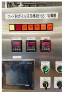
10℃以下の冷水で冷却する工程
