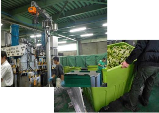
当社では、排出される動植物性残渣を業者に委託し堆肥化、飼料化、メタン発酵、焼却などすることで処理していますが、相模原エコセンター、東海エコセンター、関西エコセンターの3拠点で工場から排出される食品の野菜くずなどの植物性残渣を圧縮・脱水を行い、ゴミ減容化に努めています。
